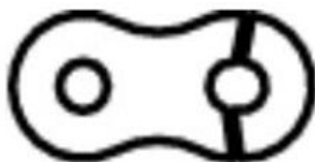
Рис. 3-31. Схема разрыва пластины звена цепи.
