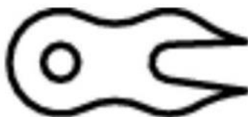
Рис. 3-33. Схема поломки цепи.
