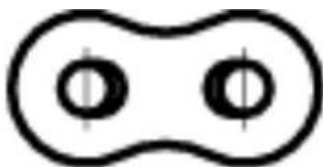
Рис. 3-35. Схема увеличенного отверстия на пластине цепи.
