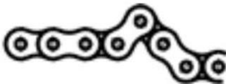
Рис.3-30. Схема застревания валика цепи из-за слишком плотного запрессовывания.
